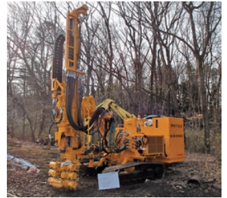
写真-1 クローラ型削孔機
