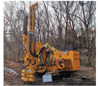
写真-1 クローラ型削孔機
