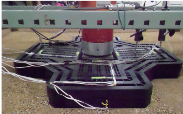
模擬地盤による変形量の確認
